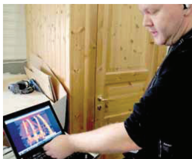
Varm ledning: Koblet til et varmesøkende kamera, kan Dag Isnes bruke PC-en til å avdekke steder med ekstraordinær varmeutvikling.
